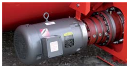
Moteur et transmission
