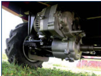
Transmission hydrostatique avec pompe EATON
